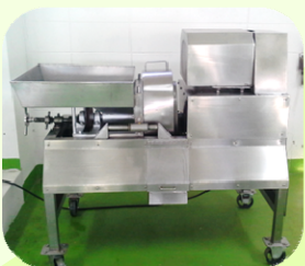
เครื่องบดสมุนไพรเปียก ใช้บดสมุนไพร เครื่องเทศ
