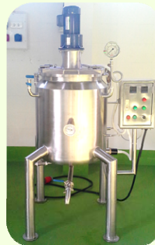
เครื่องกวนผสมสองชั้น ใช้กวนผสมวัตถุดิบของเหลว อัตโนมัติ โดยใช้ความร้อนและ การกวน
