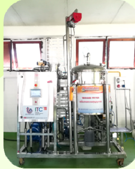
เครื่องทอดสุญญากาศ ใช้ทอดอาหารภายใต้สภาวะ สุญญากาศ เพื่อรักษาคุณค่า อาหาร
