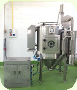
เครื่องอบแห้งแบบพ่นฝอย ใช้แปรรูปวัตถุดิบของเหลว เป็นผงละเอียด
