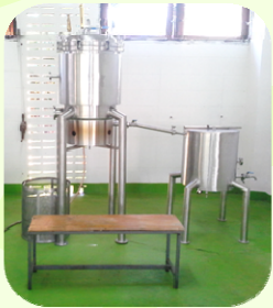
เครื่องต้มสมุนไพรแรงดัน ใช้ต้มเคี่ยววัตถุดิบ/ นึ่งฆ่าเชื้อ ด้วยความร้อนและแรงดัน
